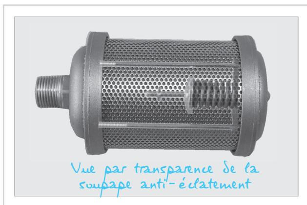
Ceci signifie que le débit instantané passant au travers du silencieux sera freiné et que la pression à l'intérieur du corps va augmenter au fur et à mesure de la durée d'exploitation. Si le service maintenance n'y prête garde et ne remplace pas le silencieux - ou le média - en temps voulu, **cette pression va atteindre le point de rupture** et le silencieux éclatera en projetant violemment des débris alentours.
